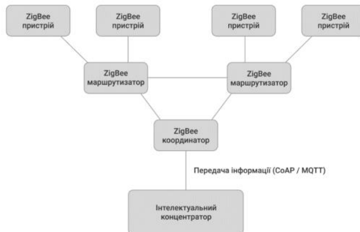
Рисунок 2.7. Сітчаста топологія ZigBee з маршрутизацією для збору інформації
