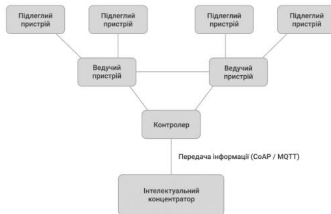
Рисунок 2.6. Сітчаста топологія BLE для збору інформації
